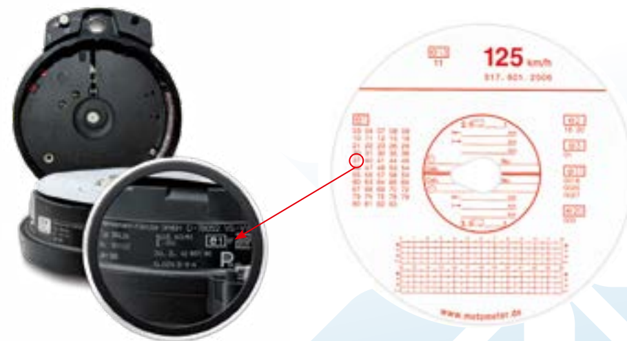
Joonis 15. Sõidumeeriku ja salvestuslehe tüübisobivuse tuvastamine
